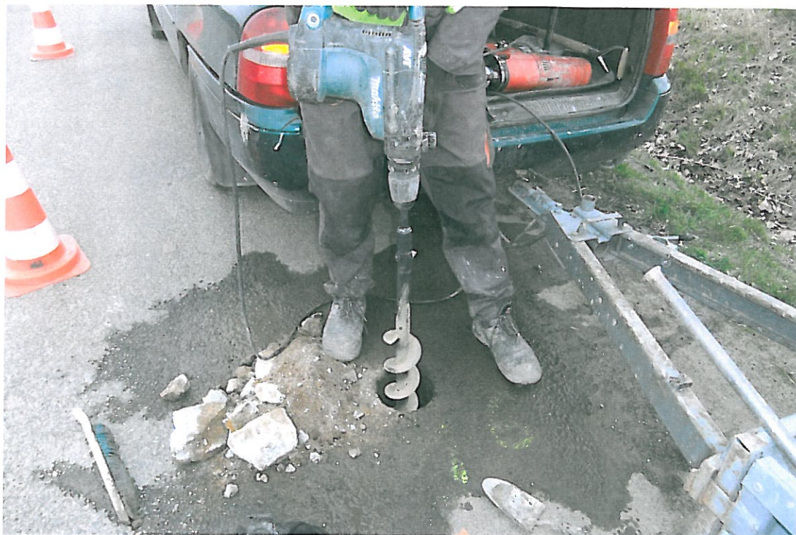
Fot . 83. Pobieranie próbki kruszywa z podbudowy, odwiertu Nr 16 w km 4+300, pas prawy
