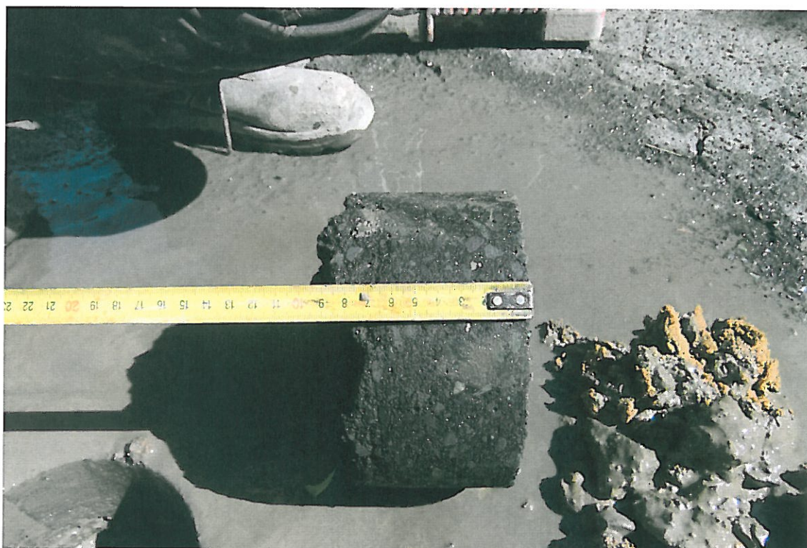
Fot . 136. Widok próbki kruszywa z podbudowy, odwiertu Nr 27 w km 8+085, pas prawy
