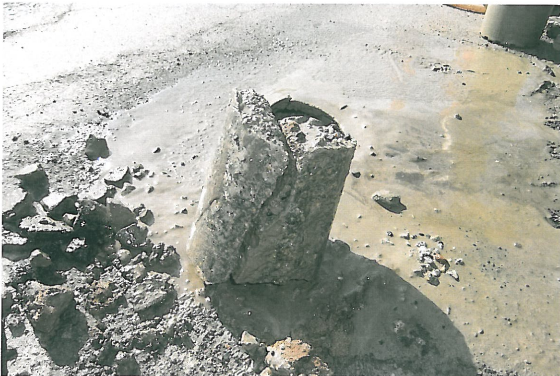
Fot . 132. Pobieranie próbki bruku z odwiertu Nr 26 w km 7+740, pas prawy
